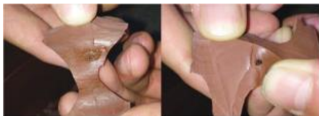
(a) 硅橡胶上的放电孔洞(外) (b) 硅橡胶上的放电孔洞(内)
