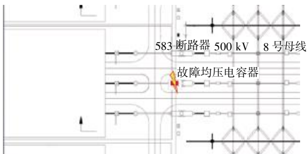
图 1 故障均压电容器位置示意图
